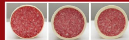
Рис. 5 Таухмасса «ОРТИМІХ Мит Кейс Джели Сырная 879», нанесенная в 1, 2, и 3 слоя (слева направо). Температура нанесения 45 °С.
